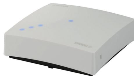
ヤマハの無線LANアクセスポイント(AP)「WLX212」。本体内部に蔵コントローラーによるオンプレミス管理に加え、クラウド型管理サービス「Yamaha Network Organizer (YNO)」に対応し設定や監視などを遠隔から一括で行える
