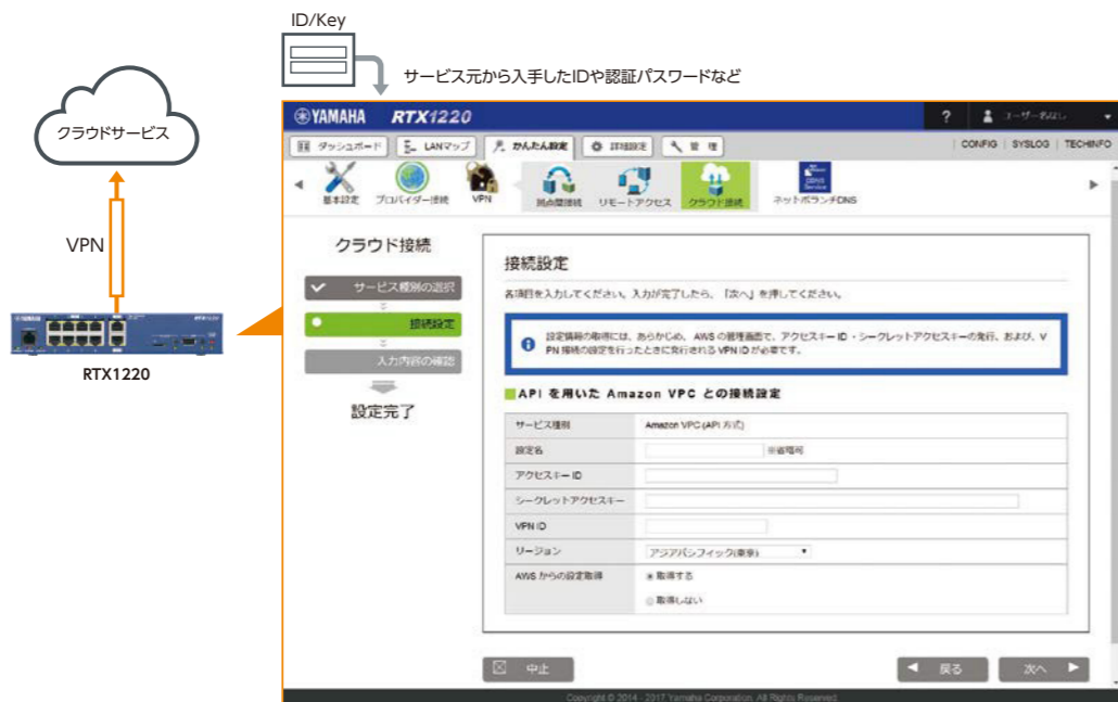
Web GUIで入力するだけで設定を自動生成し、VPN接続が可能に
