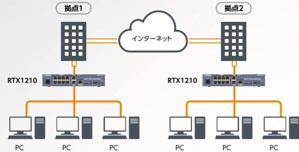
LAN間接続VPNは、会社の各拠点のLAN同士を接続する形態です。VPN接続方式としては、IPsecやPPTPなどが使われます。VPNを構築するには、各拠点にVPN接続方式に対応したルーターが必要です。
