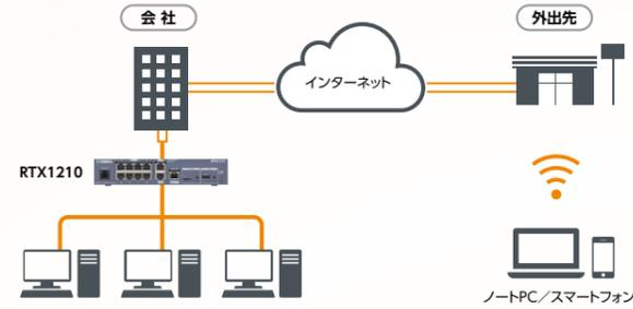
リモートアクセスVPNは、外出先のPC、スマートフォンなどからインターネットを経由して、会社のLANに接続する形態です。VPN接続方式としては、L2TP/IPsecなどが使われます。VPNを構築するには、会社側にVPN接続方式に対応したルーターが必要です。外出先にはYMS-VPN8をインストールしたPC、またはVPN接続方式に対応したスマートフォンなどが必要です。
